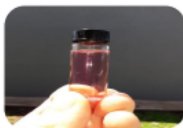
Toma de muestras y aplicación de reactivo para medición de cloro.
