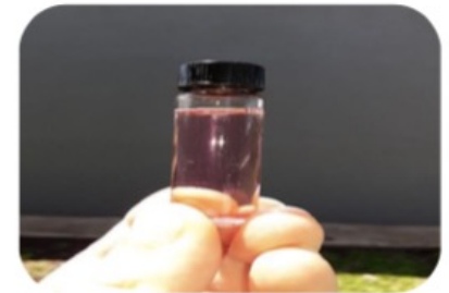
Toma de muestras y aplicación de reactivo para medición de cloro.
